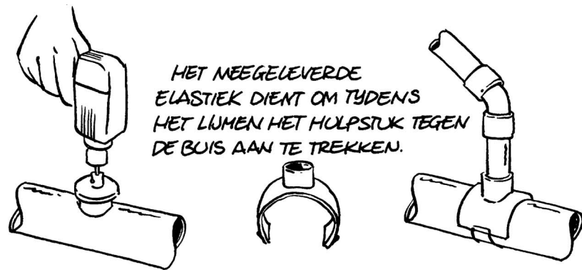
Fig. 4.10 Aansluiten van riolering op een bestaande ondergrondse leiding.
